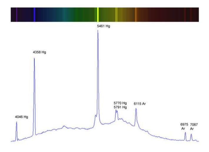
Tali luci contengono miscele di mercurio e argo e possono essere messe direttamente davanti al telescopio nel momento in cui si effettua l'immagine di calibrazione.
