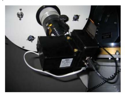
Il DSS7 è uno strumento a bassa dispersione adatto per l'indagine astronomica con telescopi di apertura modesta (funziona già egregiamente con un 20 cm). Una struttura leggera e compatta lo rende particolarmente adatto ad essere ospitato "a bordo" di strumenti amatoriali, senza comprometterne il bilanciamento ed il corretto inseguimento.
