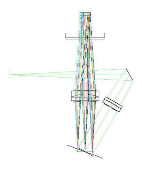
La luce entra attraverso la fenditura e viene riflessa e collimata attraverso una lente di collimazione. Il fascio luminoso arriva poi sul reticolo di diffrazione che riflette con angoli diversi le varie lunghezze d'onda, attraversando una lente di messa a fuoco ed arrivando infine sulla superficie del CCD.
